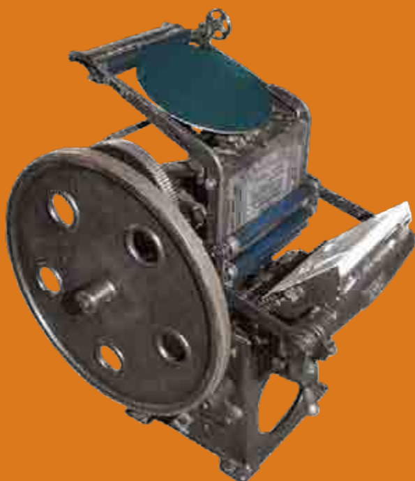
Impressora tipográfica manual vertical Tip-Top, marca Bautzen, de origem alemã. Fabricante: John Werk (1922). Utilizada para impressão de convites, boletins, diplomas e certificados. Em ferro, com prato giratório para passar tinta, composta de quatro rolos
