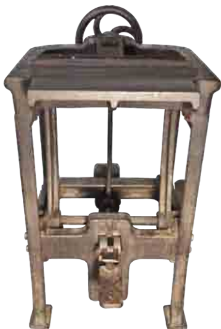
Prensa de bater encaixe utilizada na encadernação de livros. Acervo do IFMT (2009)
