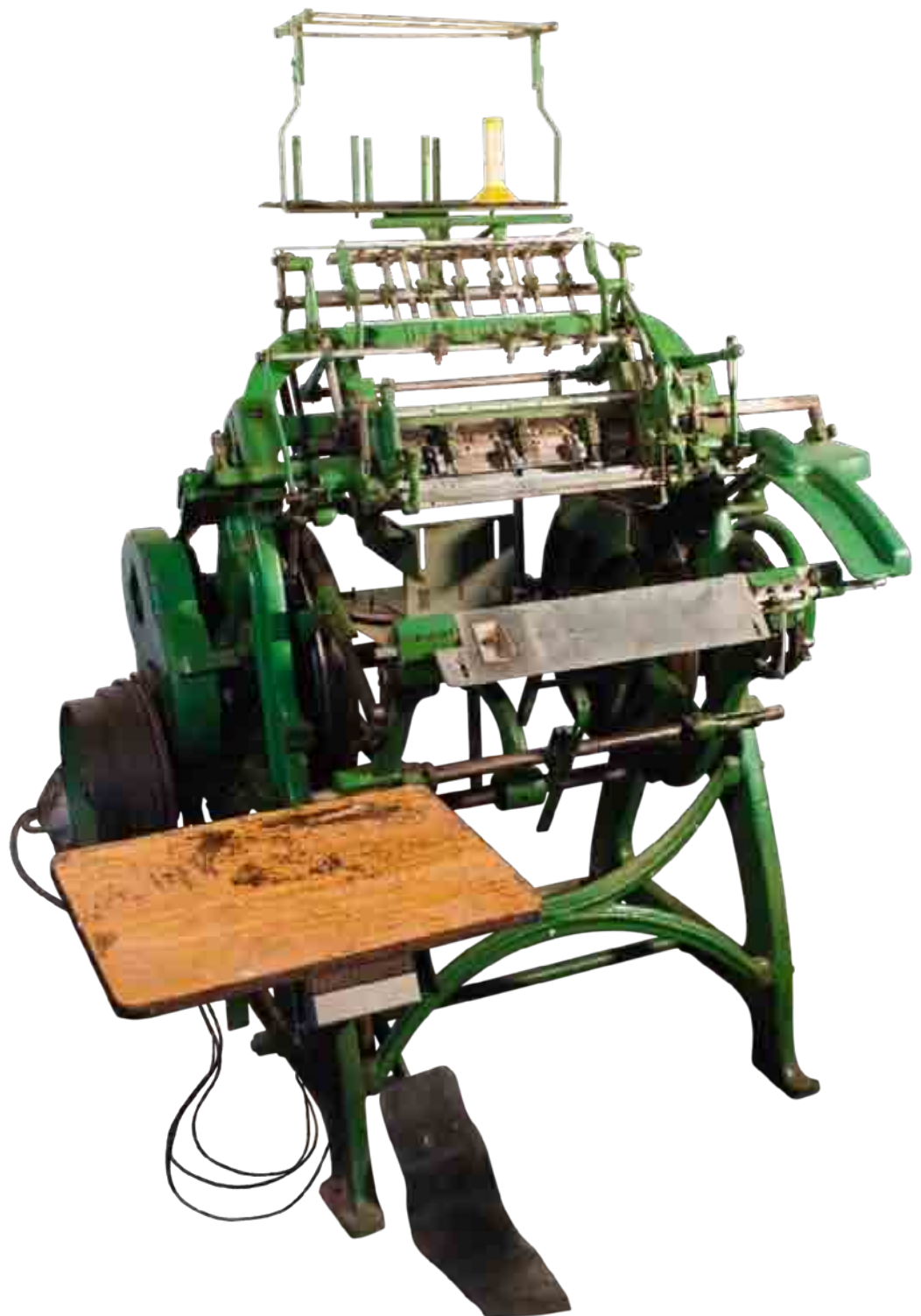
Máquina de costurar livros da Encadernadora Paula, em Várzea Grande. Fabricada pela Gebrüder Brehmer em Leipzig, na Alemanha, no final do século XIX, é uma das mais antigas do Brasil em perfeito funcionamento. Abaixo, detalhe das agulhas de gancho e costura (2009)
